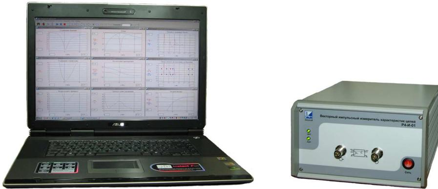
Рисунок 15 – Векторный импульсный измеритель характеристик цепей P4-И-01 (справа) и компьютер (слева) с установленным программным обеспечением ИмпульсМ, обеспечивающим работу измерителя
